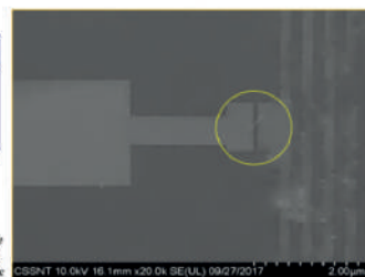
FABRICAREA UNUI NANO-FET CU EBL
