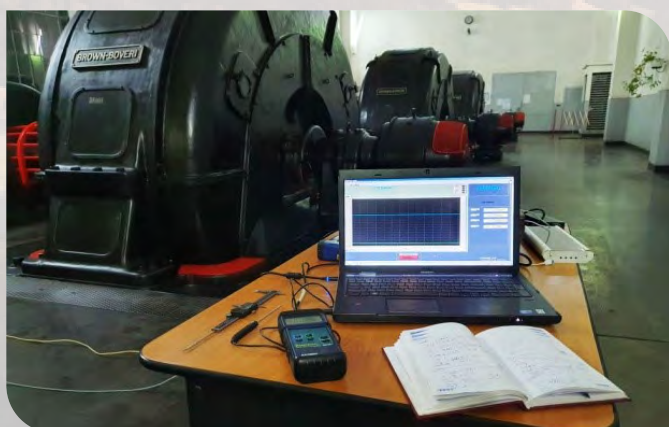
Sistem de monitorizare și determinare a parametrilor hidraulici și electrici la o centrală hidroelectrică.
