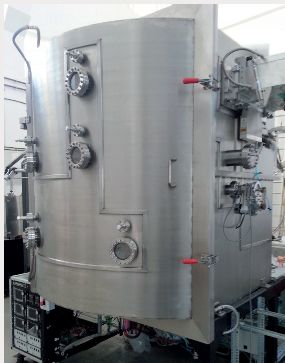
Fig. 1 Instalație pilot de depunere combinatorie a materialelor metalice, ceramice și compozite pentru bariere termice și protective în condiții extreme
