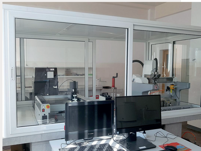
Fig. 1 Echipament de printare 3D a materialelor ceramice, compozite și hibride cu aplicații în medicina regenerativă
